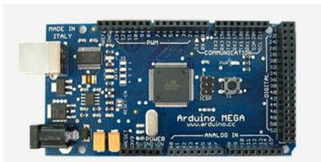
Figura 5 - Arduino Mega. Utilizado para aquisição e tratamento dos dados coletados
